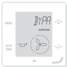
Zur Einstellung der Wärmerückgewinnungssteuerung der Bypass-Funktion für eine bestimmte Dauer.
