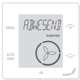
Diese Funktion schaltet die Lüftung für eine eingestellte Zeitspanne auf die niedrigste Geschwindigkeit.
